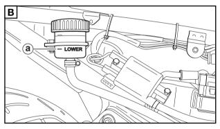
CHECKING THE BRAKE HOSES/ BLEEDING THE HYDRAULIC BRAKE SYSTEM
